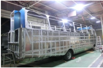
水陸両用バスの枠組製造
